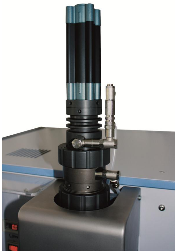
Obr. 6. Nový modul automatického čištění analyzátoru G4 ICARUS .
