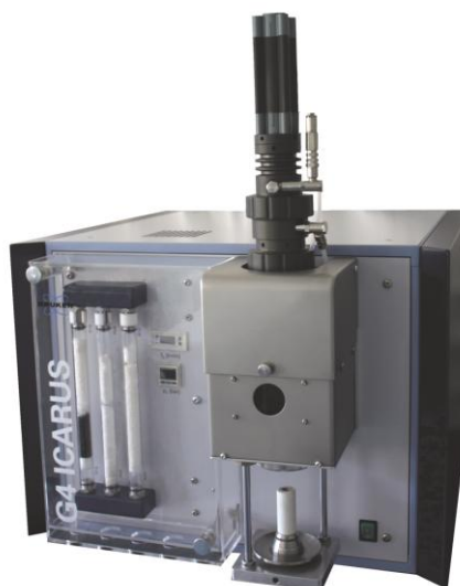
Obr 2. Analyzátor G4 ICARUS CS HF pro stanovení uhlíku a síry s modulem automatického čištění.
